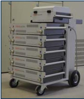
Le système BALTO a été développé pour générer des courants d'essai DC très élevés et précis afin de pouvoir effectuer des essais fonctionnels sur les disjoncteurs ultra-rapides DC.
