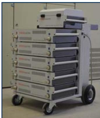
Il sistema BALTO è stato sviluppato per generare correnti d'intensità molto elevate per poter effettuare i test funzionali sugli Interruttori extrarapidi in CC. Queste correnti elevate sono inviate nel circuito principale dell'Interruttori extrarapidi in CC. Con questi test il circuito completo può essere controllato attraverso i convertitori di corrente e la rete di protezione.
