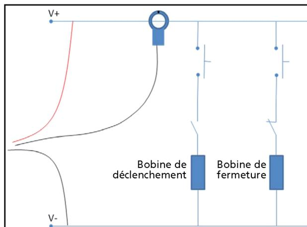
**Figure 1 :** Points de mesure de courant de la bobine et de la tension de contrôle. Le disjoncteur étant en service, il n'est pas possible d'utiliser la méthode conventionnelle de chronométrage des contacts principaux en raccordant les cordons de part et d'autre de la chambre de coupure. Des pinces ampèremétriques installées au secondaire des TC sur chaque phase permettent de détecter l'extinction des courants et donc de mesurer le temps de déclenchement.
