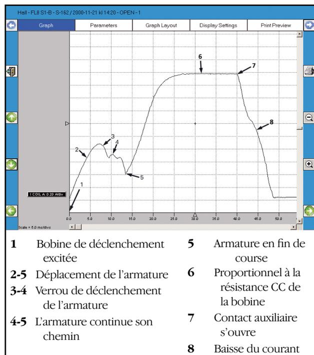
Exemple du courant de bobine sur un disjoncteur
