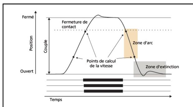
Diagramme de déplacement et chronométrage pour une séquence F-O.
