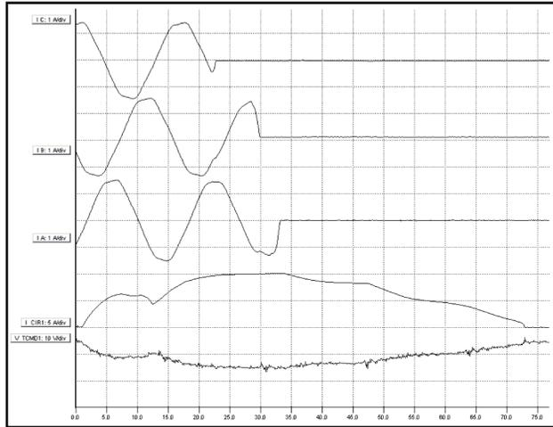
Figure 4 : Exemple de mesure des 3 phases, d'un courant de bobine et de la tension de contrôle.
