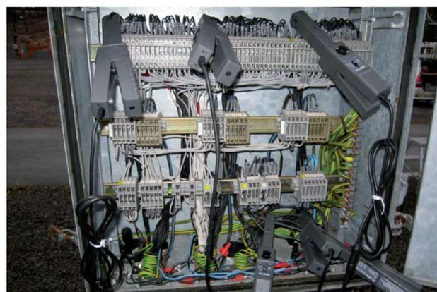
**Figure 3 :** Armoire de contrôle avec les pinces ampère métriques
