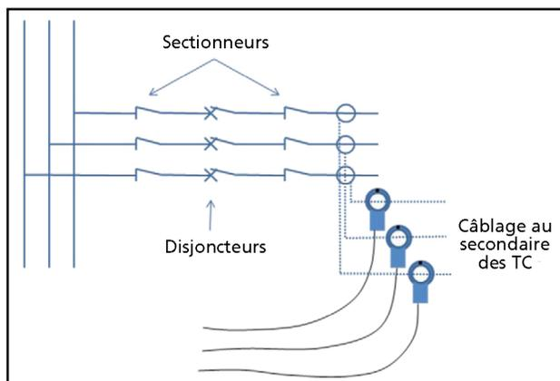
**Figure 2 :** Points de mesure des courants de ligne.
